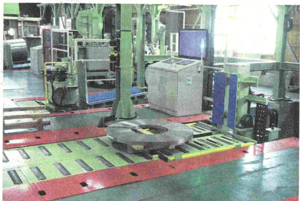
鋼板工業製のコイル自動梱包ライン
