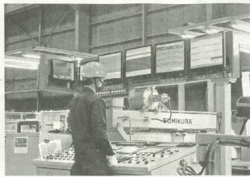
ペーパーレス化を実現したCCC現場（モニタ画面で作業工程・加工指示を確認）
